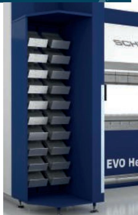
Opzione: Armadio portautensili WZS 2500 sul lato sinistro della macchina per lo stoccaggio degli utensili
